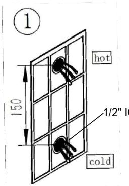
Stellen Sie sicher, dass die Warm- u. Kaltwasserleitungen in einer Höhe von 1050mm verbaut werden. Vor dem Einbau müssen die Leitungen gespült und auf Dichtigkeit geprüft werden. Die Warm- u. Kaltwasserleitungen müssen vertikal zueinander angeordnet sein. Der Abstand von 150mm zueinander (Mitte-Mitte Rohr) muss unbedingt eingehalten werden. Gewinde bauseits G1/2" Innengewinde.
