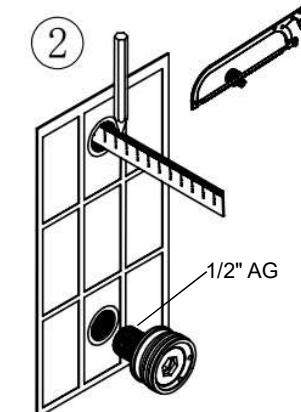
Ermitteln Sie das Tiefenmaß der Innengewinde der Wasserleitungen und notieren Sie das Maß. Es darf keine Lücke zwischen der Wand und dem Montagefitting entstehen. schneiden Sie den Überstand des Aussengewindes am Fitting auf das passende Maß ab.
