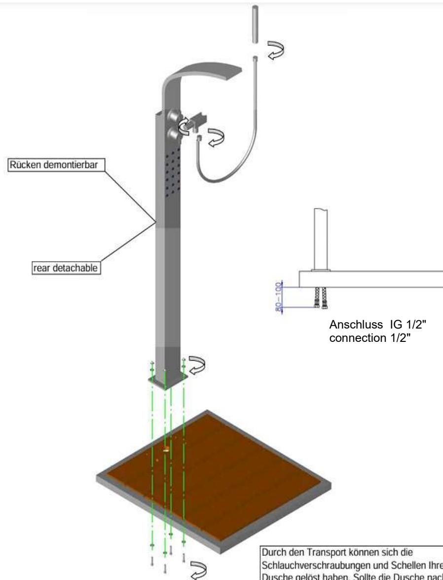
Durch den Transport können sich die Schlauchverschraubungen und Schellen Ihrer Dusche gelöst haben. Sollte die Dusche nach dem Erstanschluss undichte Stellen aufweisen, bitten wir Sie daher, die Rückwand der Dusche abzuschrauben und die Verbindungen nachzuziehen.
