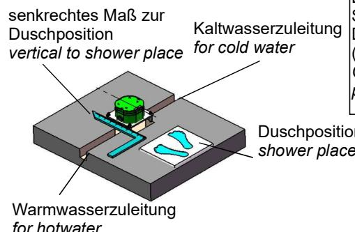
Legen Sie die Position der Montagebox fest. Beachten Sie bitte den Abstand zur Duschposition von 750 mm. Danach wird die Montagebox in den Boden eingebracht (bitte entsprechendes Loch vorbereiten)
