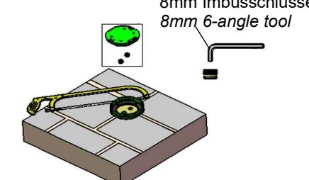
Vergewissern Sie sich, dass die Montagebox vertikal gerade und zentriert auf Sie ausgerichtet ist. Nun montieren Sie die Montagebox mit den vier Ankerschrauben M8. Bitte beachten Sie, dass der fertige Boden (Fliese oder ähnliches) höher als die Bodenlinie und niedriger als die Mittellinie der Montagebox sein muss.
