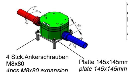
Verbinden Sie die Anschlüsse der Montagebox mit den entsprechenden Leitungen für Kalt- und Warmwasser. Dichtigkeitsprüfung nicht vergessen.
