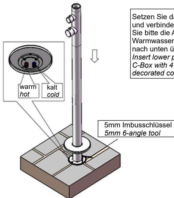
Setzen Sie das Unterteil der Dusche auf die Montagebox und verbinden Sie beide mit vier Schrauben. Beachten Sie bitte die Anordnung der Zuleitungen Kalt- und Warmwasser. Danach schieben Sie die Abdeckrossette nach unten über die Montageplattform.
